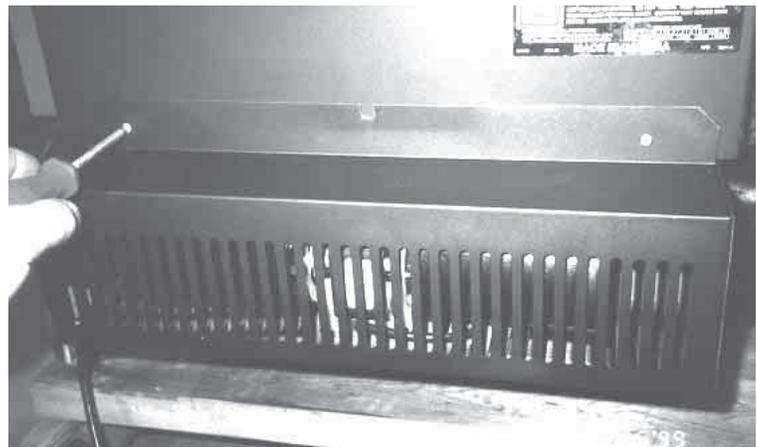
Lorsque les déflecteurs d'air latéraux du dessus sont posés sur le poêle au bois non encastré Vista ou Summit, la circulation d'air vers le devant du poêle est augmentée. Mais ils ne sont pas conçus pour être posés sur le modèle Super 27.
